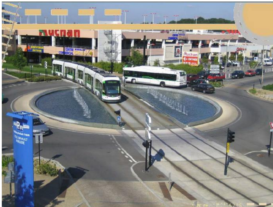
Mynd 12: Dæmi um hvernig léttlest í miðlegu er leidd í gegnum hringtorg (Nantes, Frakkland).
