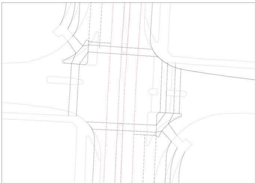
Mynd 16: Dæmi um lítil gatnamót og breytingar á þeim. Gatnamót fyrir breytingu (ljósgráar línur) og eftir breytingu (svartar línur).
